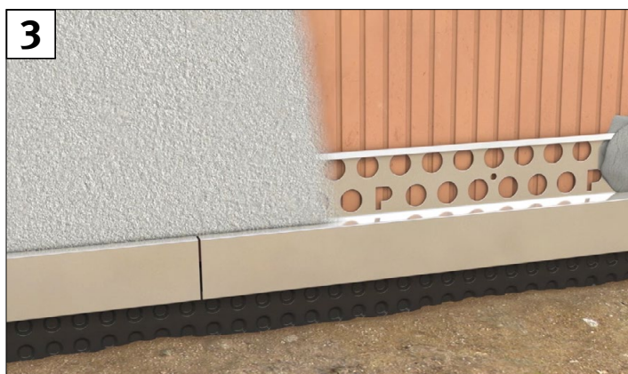
3 Noppenbahnprofil kann nach dem Aushärten der Ansetzbatzen auf 14 mm Putzdicke eingeputzt werden
